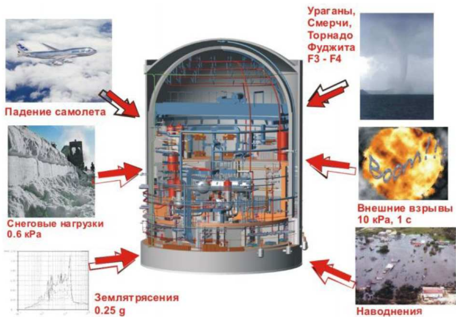
Рисунок 2.1.2 Номенклатура и количественные характеристики природных и техногенных воздействий, на которые рассчитана защитная оболочка реактора
